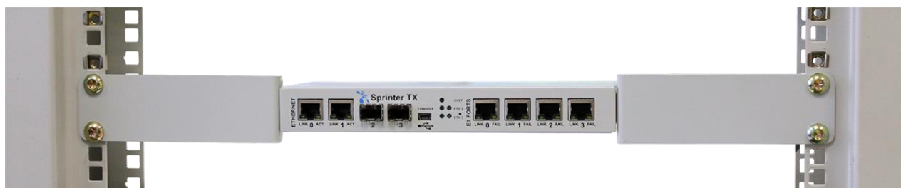
Рисунок 3.1 - Крепление Sprinter TX (11) в стойке
