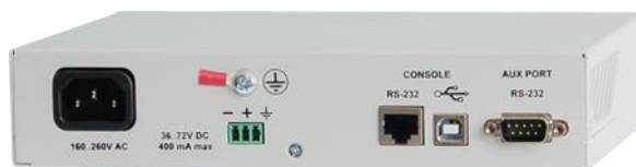
Рисунок 3.3 - Задняя панель мультиплексора-коммутатора Sprinter TX (12)
