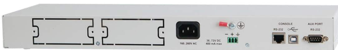
Рисунок 3.4 - Задняя панель мультиплексора-коммутатора Sprinter TX (20)
