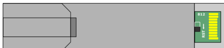
Рисунок 1.1 – DIP-переключатель в положении "RST" (заводской IP-адрес)
